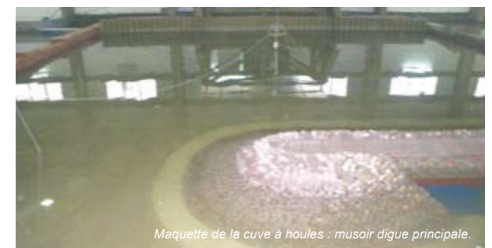
Maquette du canal à houles : digue principale.
